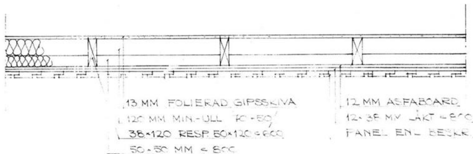
Figur 22 Del från ritningsunderlaget, visar väggens konstruktion från 70-talet [Källa: Borås Stad].
